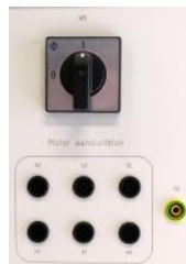
Gesimuleerd motoraansluitblok en werkschakelaar
