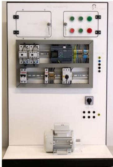
Foutensimulator PLC schakelingen naar keuze met Siemens Logo! of Eaton Easy.
