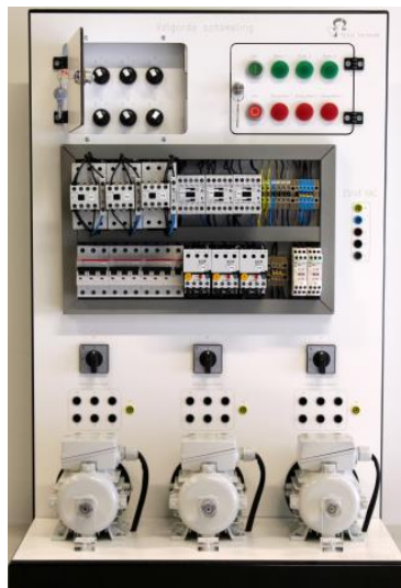
Foutensimulator PLC schakelingen naar keuze met Siemens Logo! of Eaton Easy.
