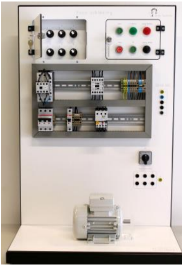
Foutensimulator basis schakeling met zoemer
