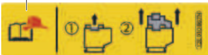
Label am Rettungstrennstellen-Stecker zur Erläuterung der Betätigung der Hochvolt-Unterbrechung. r001_052
