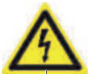
r003_142 Warnung vor gefährlicher Elektrischer Spannung nach DIN 4844-2 (BGV A8)
