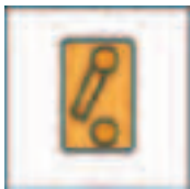
Symbol „Hochvolt-Rettungstrennstelle“ im Rettungsdatenblatt
